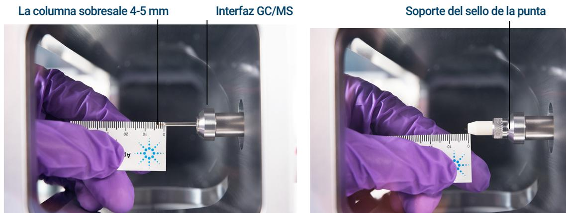
Figura 21. Instalación de una columna capilar en la interfaz de GC/MS para una fuente EI HES o HES 2.0
