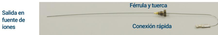
Figura 15. Cola del GC/MS 9000 extraída de la interfaz del GC/MS
