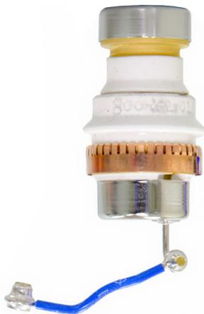
Figura 74. Cuerno multiplicador de electrones para un detector de la serie 2
