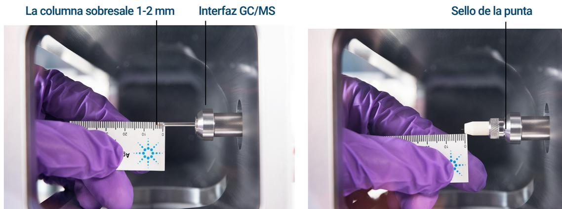
Figura 5. Instalación de una columna capilar en la interfaz de GC/MS para una fuente EI HES o HES 2.0
