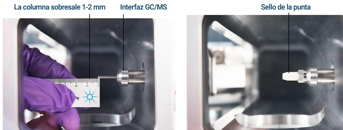
Figura 4. Instalación de una columna capilar en la interfaz GC/MS para una fuente EI XTR o CI
