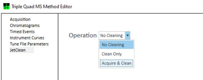
Figura 31. Panel JetClean del editor de métodos TQ MS
