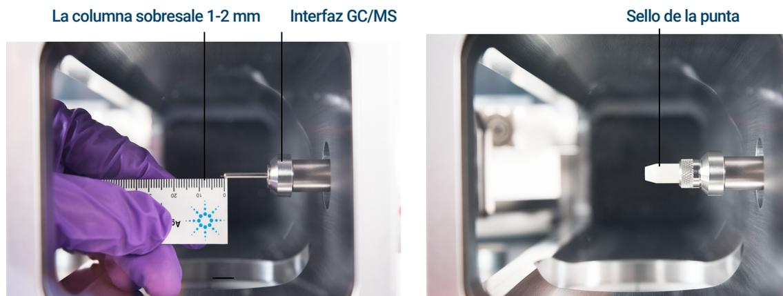
Figura 20. Instalación de una columna capilar en la interfaz GC/MS para una fuente EI XTR o CI
