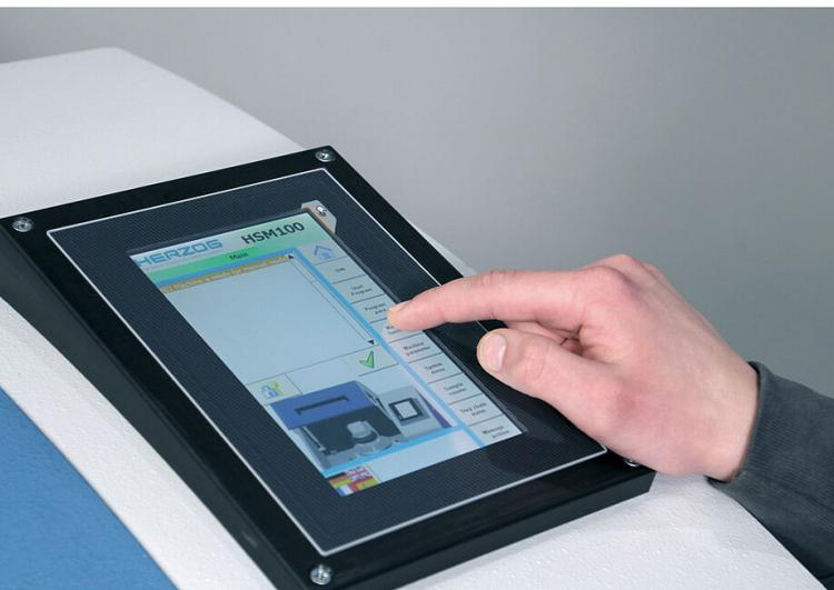
La máquina se maneja a través de una pantalla táctil de 7 pulgadas integrada. El tamaño del panel y la navegación clara e intuitiva permiten un acceso sencillo a todas las funciones de la máquina.
