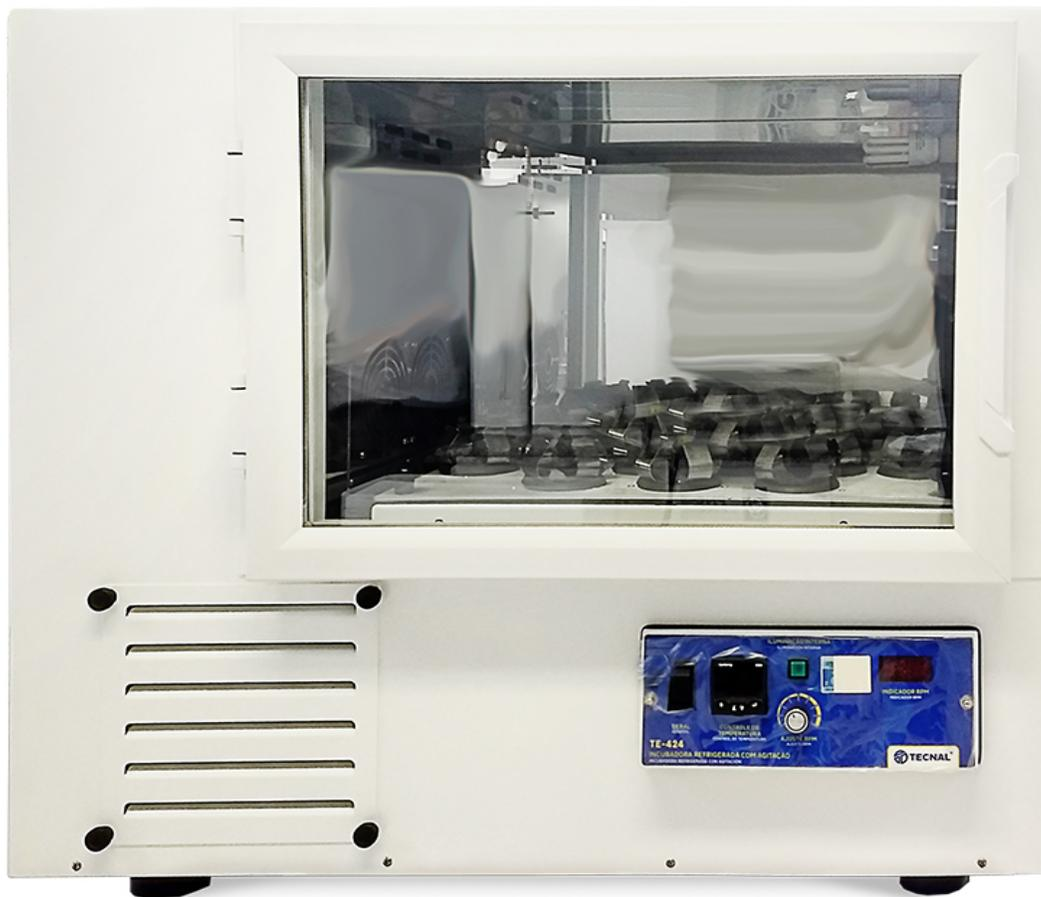
Utilizada para incubar muestras que requieren agitación orbital y temperatura controlada; como medio de cultivo para el crecimiento de microorganismos, y análisis en el campo de la bioquímica.
