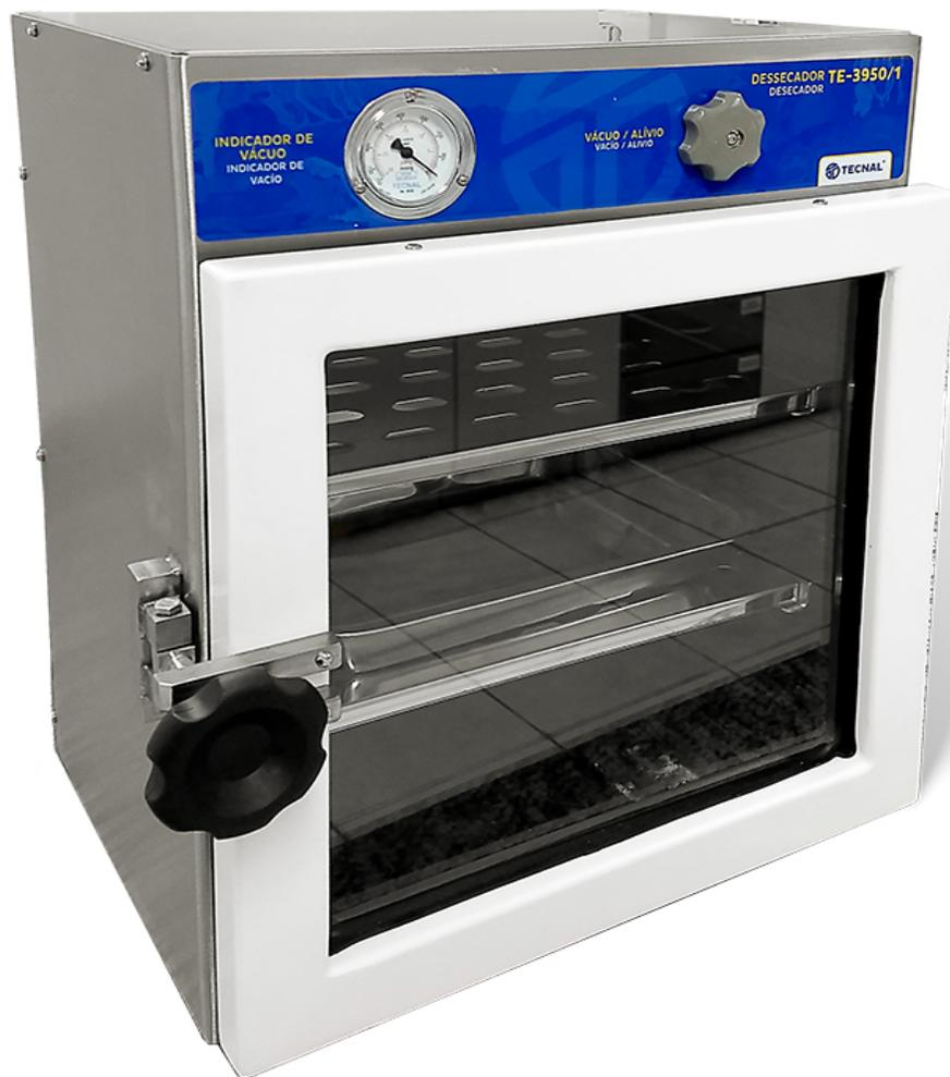
Utilizado para enfriamiento y almacenamiento de muestras y productos en atmósfera anhidra.
