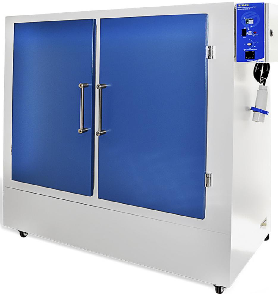
Utilizado para secado de material, vidrierías y muestras en general, pudiendo ser utilizada para determinación de humedad, utilizando o no el sistema de circulación y renovación de aire.
