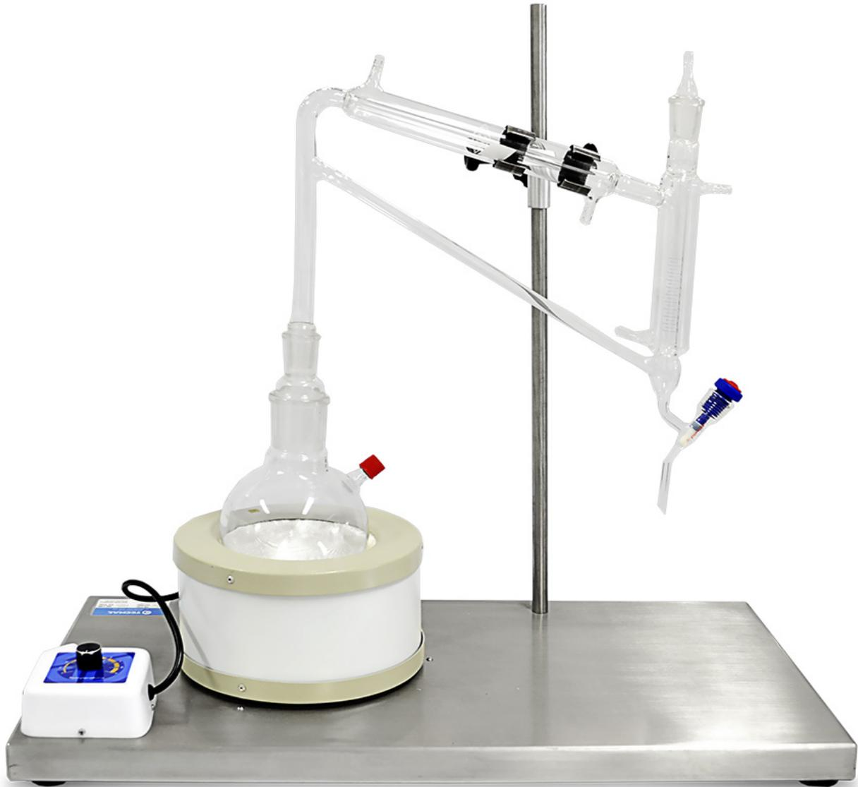
Utilizado en la extracción por hidrodestilación (arrastre de vapor) de aceites esenciales, compuestos volátiles presentes en plantas aromáticas, y que son utilizados por sus aromas, sabores, colores y propiedades medicinales en la producción de fármacos, antioxidantes, biocidas, perfumes, repelentes, desengrasantes, alimentos, bebidas, cosméticos, en la industria química y en la investigación y el desarrollo.
