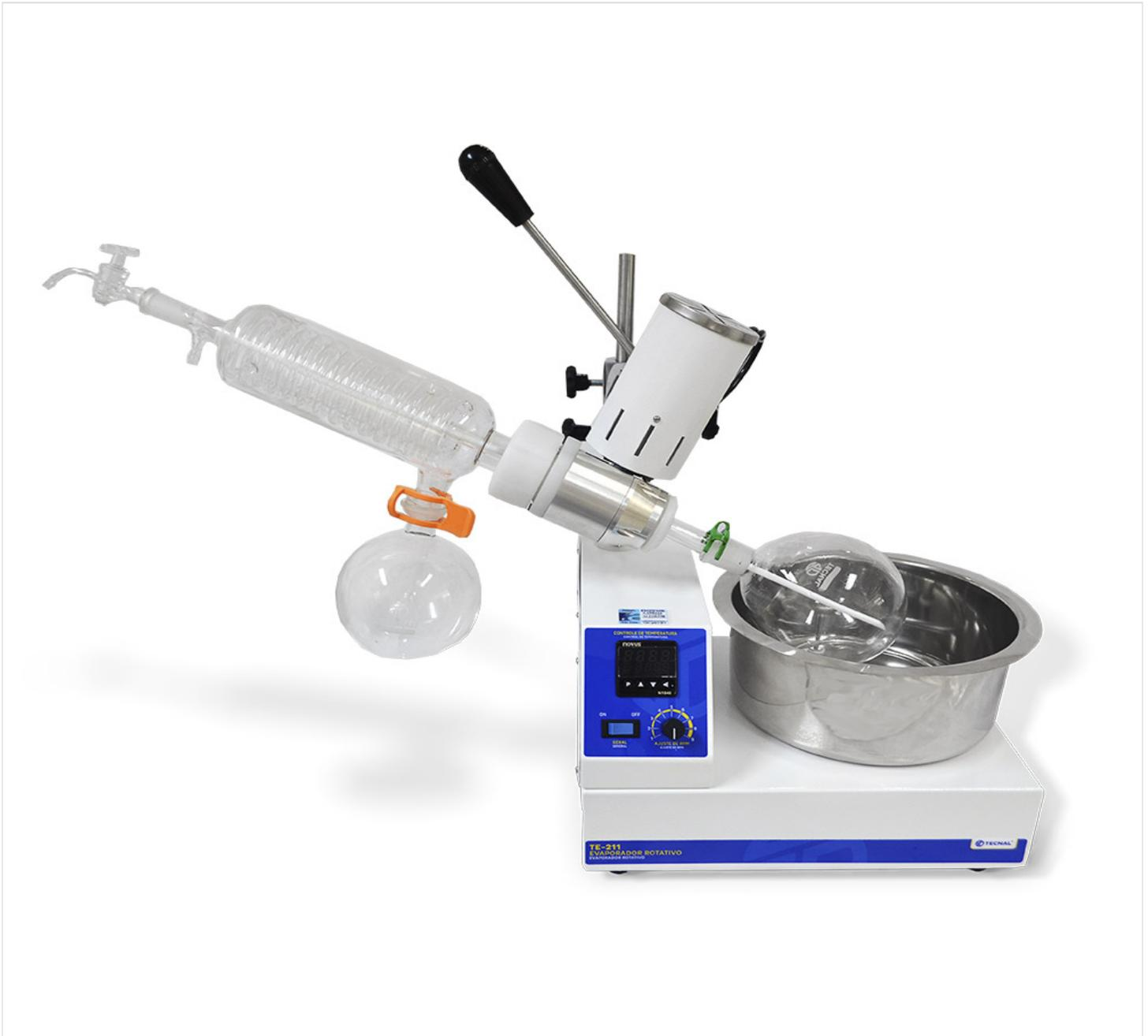
Se utiliza para destilar y recuperar solventes luego de procesos de síntesis, concentrar muestras con bajas concentraciones de soluto hasta alcanzar el punto de cuantificación, y secar muestras sólidas luego de procesos de percolación, con temperatura controlada y posibilidad de usar vacío, permitiendo que la destilación sea realizada a temperaturas más bajas, evitando la degradación de compuestos termolábiles.
