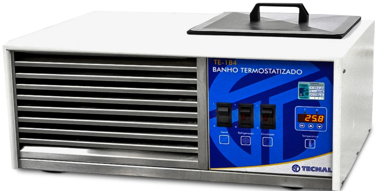
Equipo utilizado para mantener la temperatura constante en sistemas de reacción, posibilitando que haya un control preciso de la temperatura. Es muy utilizado en varios sectores de la industria, laboratorios y universidades, pues la circulación de agua es realizada en circuito cerrado, evitando desperdicios.
