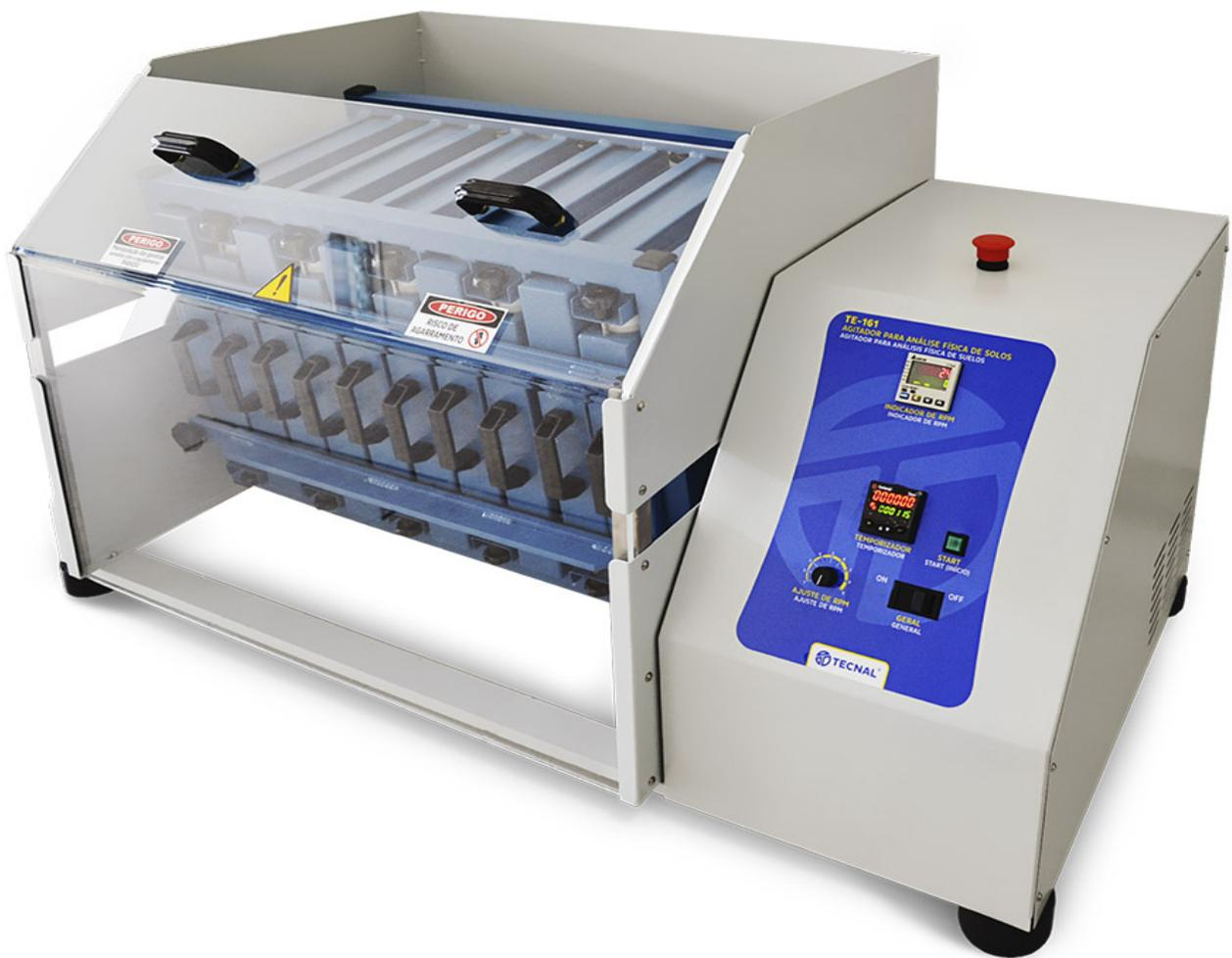
Utilizado para agitar muestras de suelo para posterior análisis físicas para medir el tamaño de las partículas a través de su densidad.
