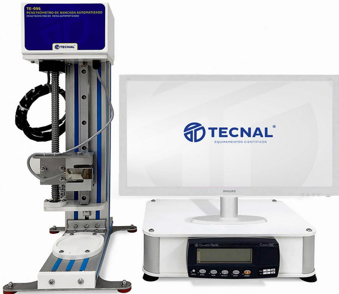
Realiza la medición de forma rápida y precisa la compactación de muestras indeformadas de suelos y frutas.
