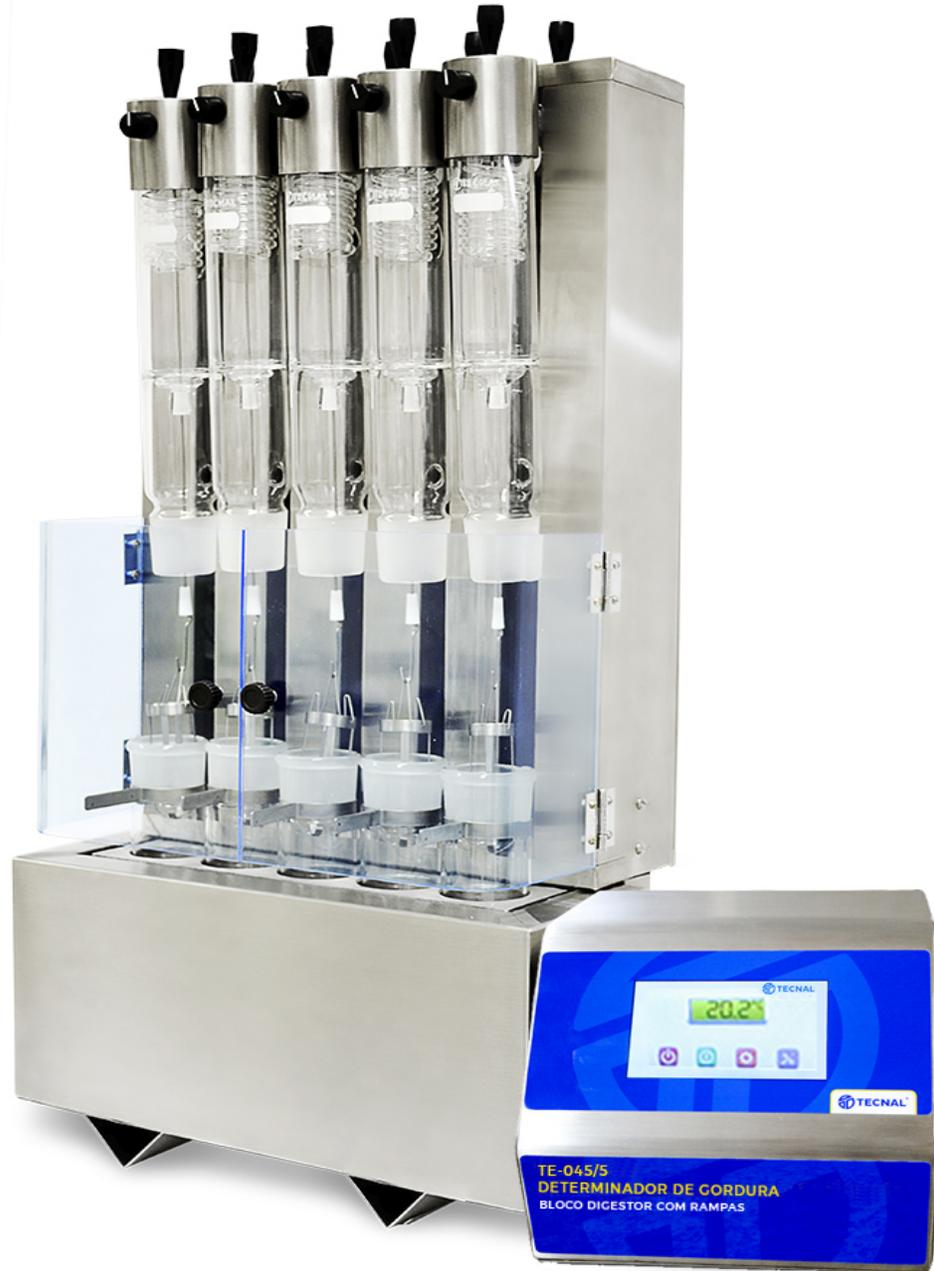
Utilizado en la extracción por disolventes en caliente de residuos grasos, lípidos y grasas, pudiendo ser utilizado en las áreas: ambiental, alimentos, bebidas, concentrados, bio-combustibles y aguas y efluentes.
