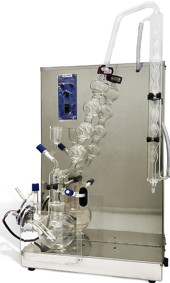
Utilizado para la destilación de bebidas alcohólicas en general (tequila, cachaza, vinos, licores, vodka, ginebra, cerveza, entre otros), destilación de vinagre, alcohol (líquido y gel) y muestras de su proceso de fabricación (crema de levadura, vinaza, flema, mosto, vino crudo, caldo), para la posterior determinación del grado de alcohol mediante el análisis de densidad.
