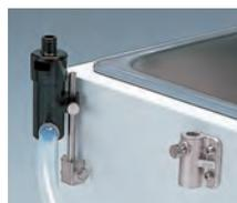
El nivel del agua puede cambiarse ajustando el nivel de desbordamiento
