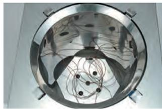
Con el sensor opcional de temperatura de muestras, la temperatura deseada de la muestra se puede mantener precisa para asegurar una esterilización segura
