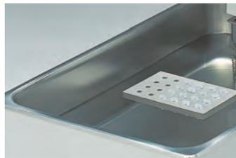
5-Flotador para microtubos
