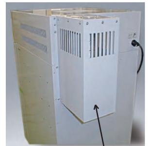
Ejemplo de horno con conducto de escape
