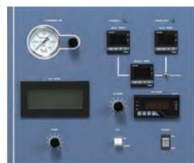
La temperatura de entrada, la temperatura de salida y la cantidad de aire de secado se indican digitalmente. Un panel táctil permite realizar ajustes, muestra el estado de las operaciones y los errores, y los ajustes de varias condiciones de operación.
