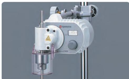
**Agitadores altamente fiables que abarcan muestras de alta y baja viscosidad con un amplio rango de rotación. Con la adopción del motor DC sin escobillas y el control de retroalimentación, se logra un alto esfuerzo de torsión y rotación estable.**
