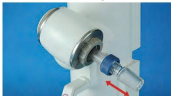
La posición de la junta rotatoria es ajustable hasta 80 mm. Útil cuando se utiliza matraces de evaporación con diferentes capacidades o cuando es necesario cambiar la posición de contacto del sello de vacío. (Patente No. 3220033)
