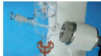
El condensador de vidrio está diseñado especialmente para prevenir el estancamiento de líquidos y reflujo, y aumentar la capacidad de enfriamiento con un 20% más de superficie que permite una destilación más rápida. (Patente No. 4597021)
