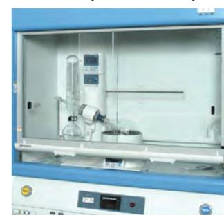
Evaporador rotatorio compacto, puede instalarse perfectamente en una campana de extracción. El condensador vertical no ocupa mucho espacio.
