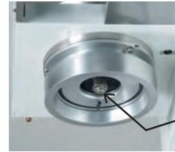
La punta de la boquilla cuenta con una boquilla para líquido y otra para gas.
