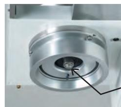
La punta de la boquilla cuenta con una boquilla para líquido y otra para gas.
