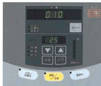
El monitor digital muestra la calidad del agua desionizada y del agua destilada
