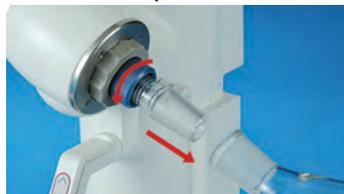
El matraz de evaporación puede ser removido fácil y rápidamente girando la tuerca.
