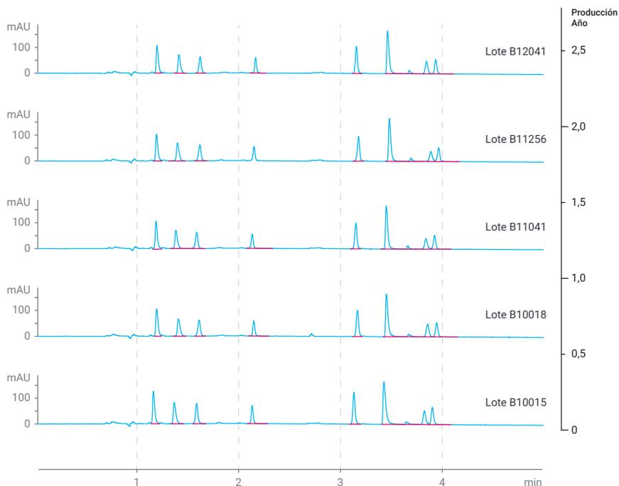
El proceso de una sola etapa crea una columna altamente reproducible tal y como puede ver en esta comparación de cinco lotes distintos de columnas InfinityLab Poroshell 120 EC-C18, 3,0 x 100 mm, 2,7  $\mu$ m.
