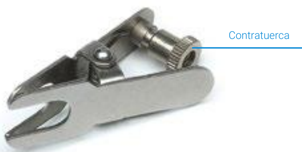
Figura 3a. Utilice la abrazadera para antorcha estándar con la antorcha inerte tanto semidesmontable como totalmente desmontable del ICP-OES.
