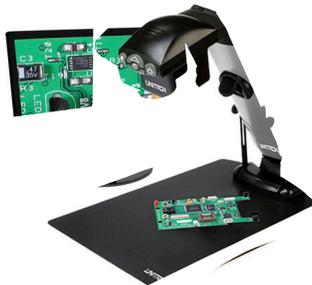
El Inspex HD 1080p es un sistema modular de inspección digital que ofrece imágenes de 1080p a 60fps. Con una luz LED integrada, captura de imagen extraíbles por USB y una amplia variedad de opciones de montaje y soporte, el Inspex HD 1080p es una solución de primera clase.
