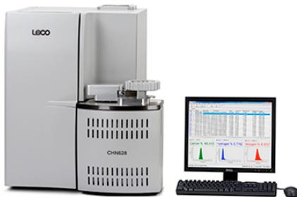
LECO® ofrece su 628CHNOS, para determinar Carbono, Hidrógeno, Nitrógeno, Oxígeno y Azufre en variedad de matrices orgánicas en menos de 6 minutos con alta precisión y exactitud. Disponible con opciones de automatización para alta frecuencia de análisis. Disponibles en otras configuraciones analíticas: CN, NS, CHN, CNS, CHNS,
