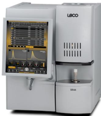
LECO® ofrece dos modelos para el análisis de Carbono y Azufre en forma simultánea, CS744 y CS844. Ambos equipos están basados en una combustión directa y detección con celdas de IR (Absorción en infrarrojo).
