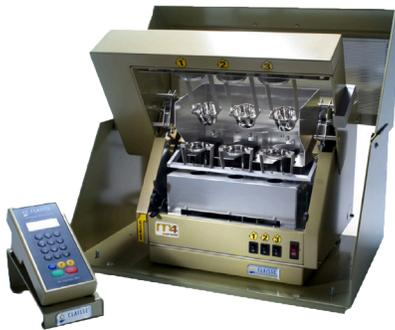
El instrumento de fusión M4 es un instrumento automático a gas de tres posiciones que prepara tanto discos vítreos para análisis vía FRX, así como soluciones para análisis vía ICP o AA. Es muy versátil porque puede procesar una amplia gama de muestras.
