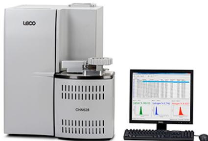
LECO® ofrece su 628CHNOS, para determinar Carbono, Hidrógeno, Nitrógeno, Oxígeno y Azufre en variedad de matrices orgánicas en menos de 6 minutos con alta precisión y exactitud. Disponible con opciones de automatización para alta frecuencia.
